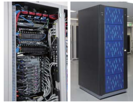
Xsigo VP780採用でスッキリしたサーバラック背面(左)とHitachi Universal Storage Platform V(右)
